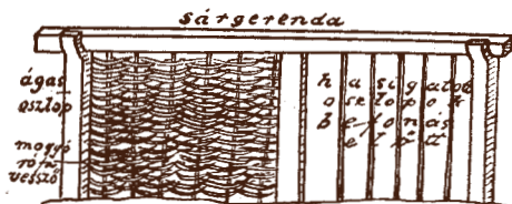
16. ábra. Régi falépítési mód sárral bevert sövényfallal. Valamikor csaknem minden ház ilyen fallal épült. Ma csak egy „pince tetejének” két falrészletében van meg. — Abb. 16. Alte Wandbaumeteode: geflochtene Rutenwand mit Lehm beschmiert. Einst waren alle Häuser so gebaut; heute nur noch eine einzige „Kellerkammer” (Ung.: pinceteteje).
